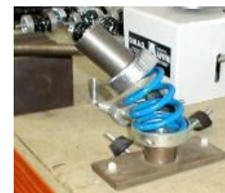
Ensayo de pandeo para medir la resistencia de los casquillos fijados al muelle
